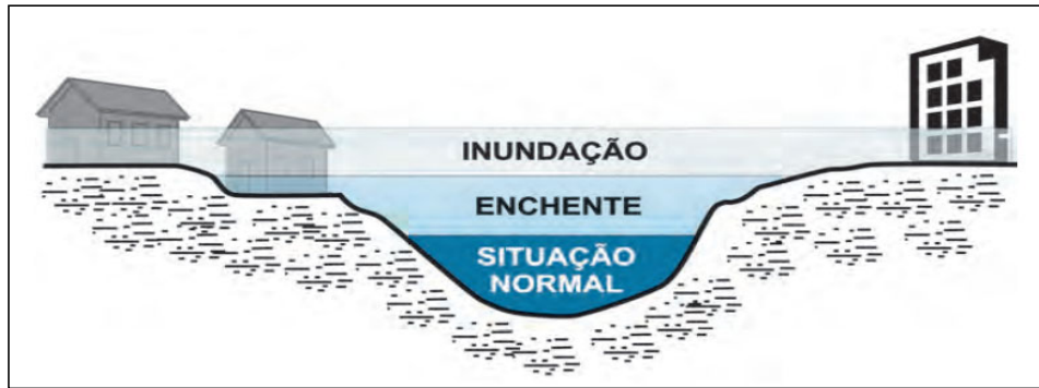
Figura 8. Perfil esquemático do processo de enchente e inundação.
