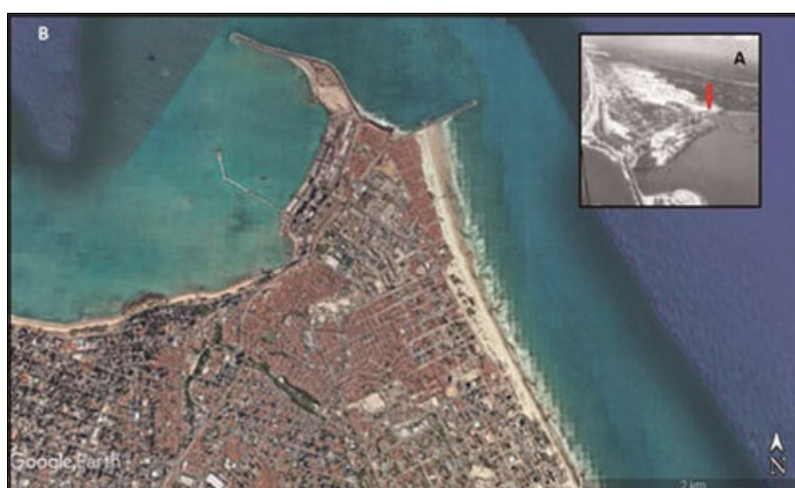
Figura 5. (A). Costa leste de Fortaleza e entorno do Porto do Mucuri, com largos campos de dunas. A seta vermelha indica a área onde o by-pass de dunas ainda ocorreria logo depois da construção do porto. (B). Completa urbanização do campo de dunas, o que resultou na interrupção do bypass de areias para o segmento norte do litoral de Fortaleza.
