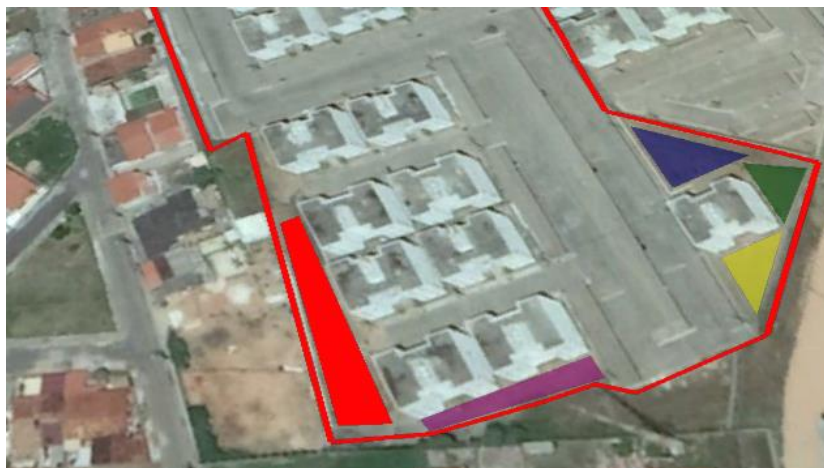
Figura 08 – Locais onde podem estar localizados os reservatórios.
