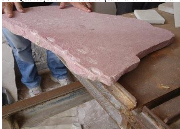
Figura 04: Quarteação em bancada de quartzite com serra diamantada.
