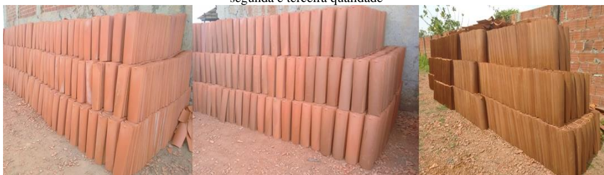
Figura 11: Qualidade diferenciada do produto final – Da esquerda para direita, respectivamente, telha de primeira, segunda e terceira qualidade
