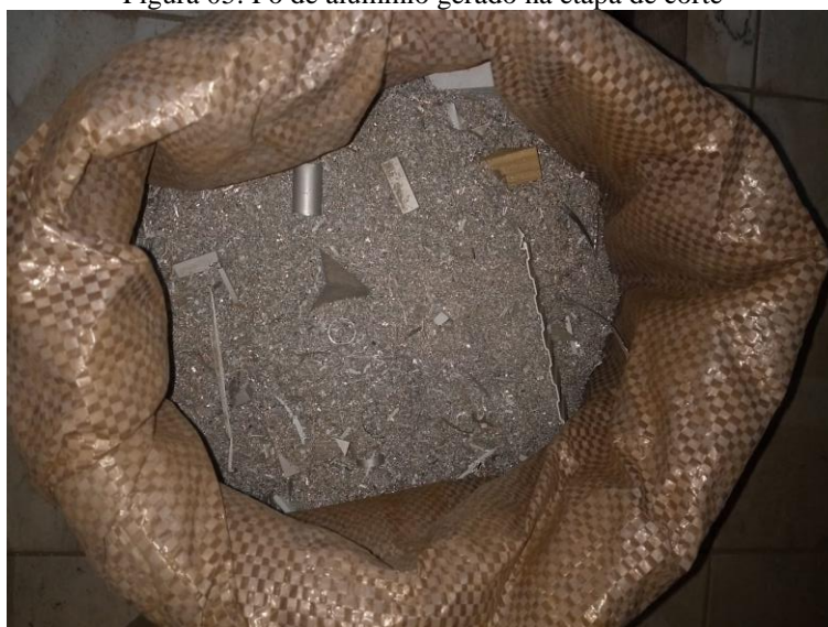
Figura 05: Pó de alumínio gerado na etapa de corte
