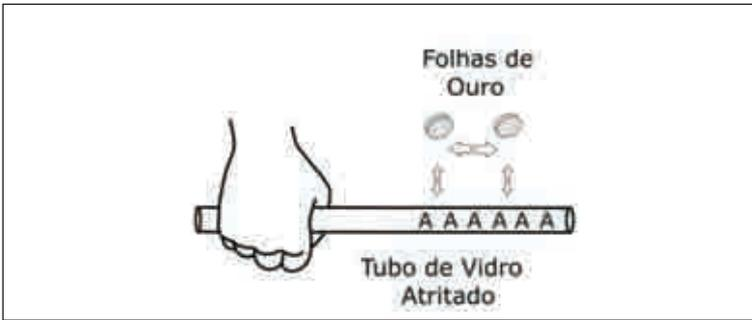
Figura 3 – Sobre um tubo de vidro eletrizado por atrito flutuam, devido à repulsão elétrica do tubo, duas folhas de ouro eletrizadas por contato com o tubo atritado, as quais também se repelem mutuamente. As setas na figura indicam a repulsão entre os corpos. A letra “A” na figura do tubo de vidro significa que ele está atritado.
